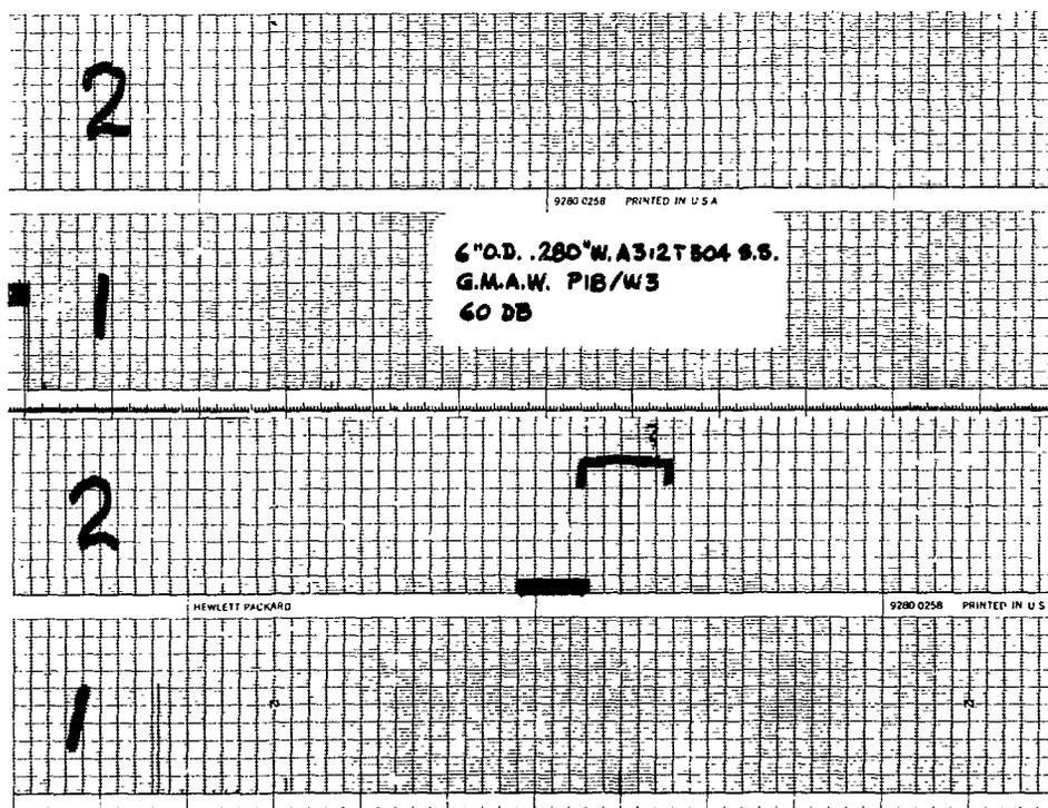
FIGURE 5 ACOUSTIC EMISSION RECORD FOR 152.4 mm OD A312T304 STAINLESS STEEL PIPE CALIBRATION TEST WELD
