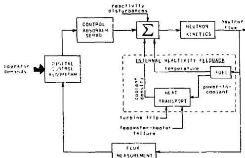
FIGURE 2 - REGULATING SYSTEM BLOCK DIAGRAM
