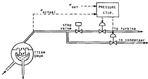
FIGURE 4 - PRESSURE CONTROLLER FOR CANDU-BLW(PB)-1200 AS A 'TURBINE-FOLLOWING-REACTOR' STATION
