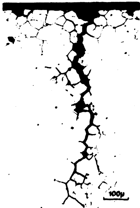
Fig. 7 - Alliage Inconel 600 (C = 400 ppm) fissuré après 9 mois.
