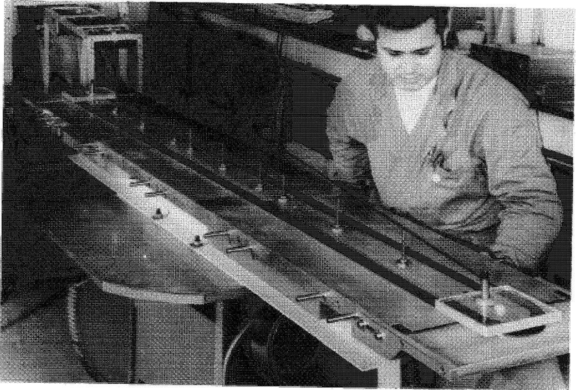
Fig. 4 Winding table
