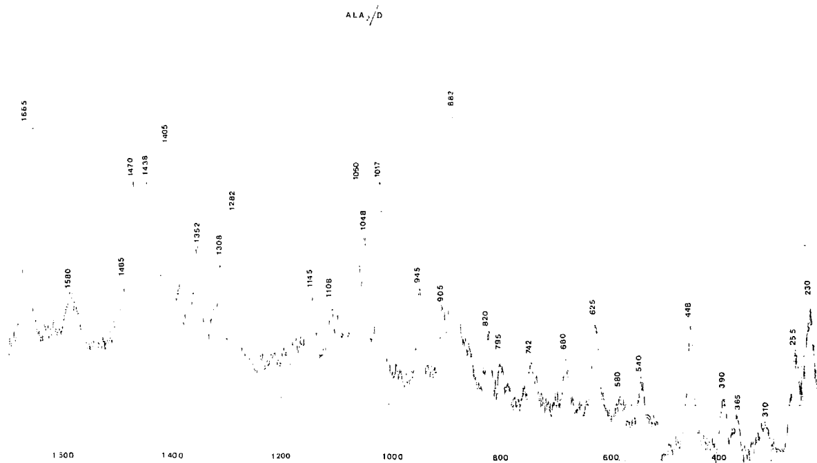
Figure 5 : Spectre Raman entre 1700 et 200 \text{cm}^{-1} de dialanine deutérié solide.
