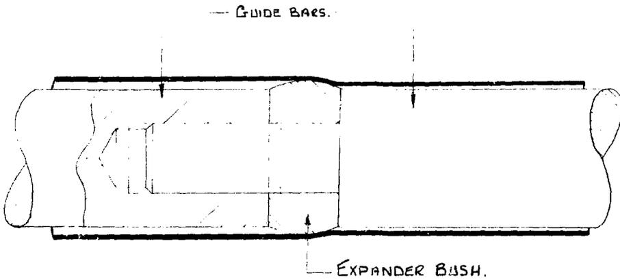
FIGURE 8 : TUBE SIZING OPERATION
