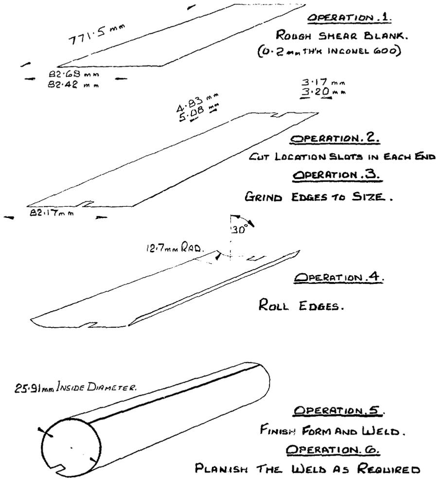
FIGURE 9 : TUBE FABRICATION PROCESS
