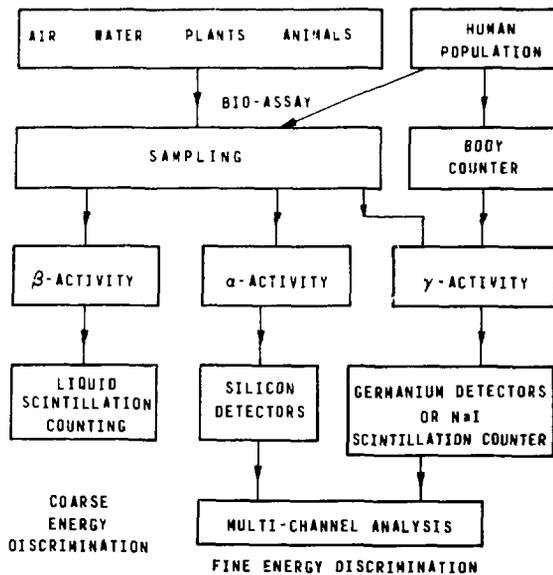
FIGURE 10. ENVIRONMENTAL RADIOACTIVITY MONITORING
