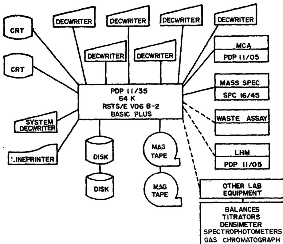
FIGURE 1 -- SCHEMATIC SHOWING THE COMPONENTS OF A LABORATORY COMPUTER SYSTEM.
