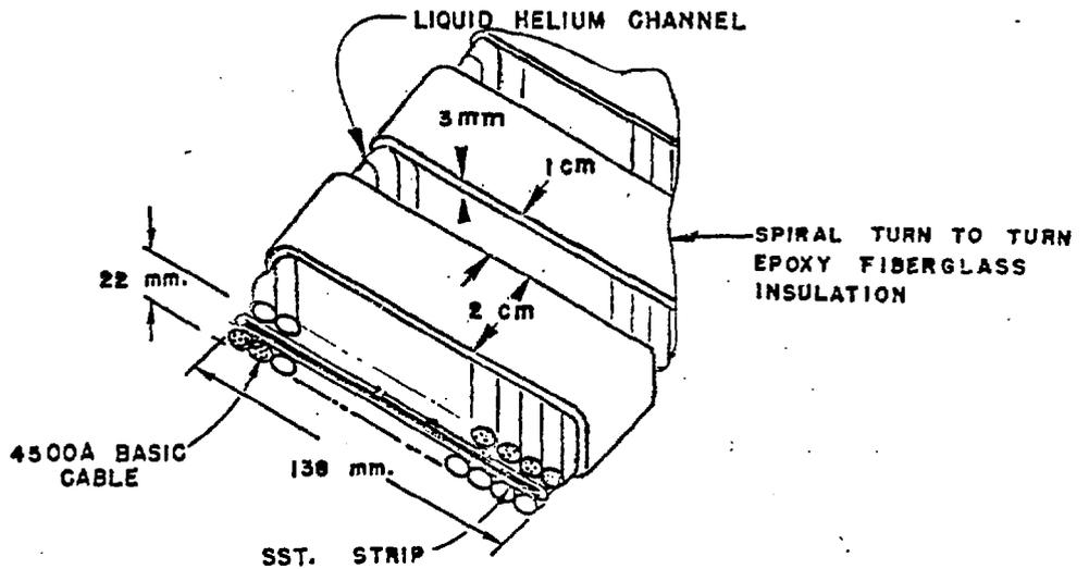
Fig. 9. 100-kA cable conductor.
