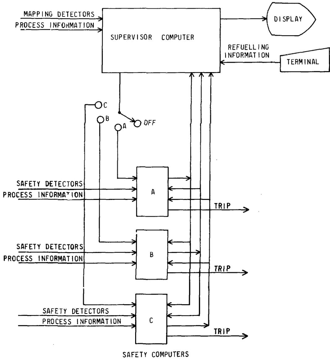
FIGURE 1 SCHEMATIC OF INTELLIGENT SAFETY SYSTEM
