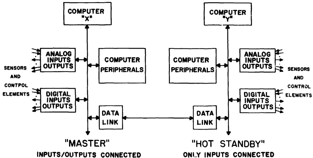
FIGURE 7 DUAL COMPUTER CONTROL OF A CANDU POWER PLANT
