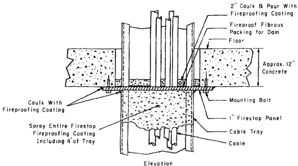
Fig. 14. Floor Penetration .
