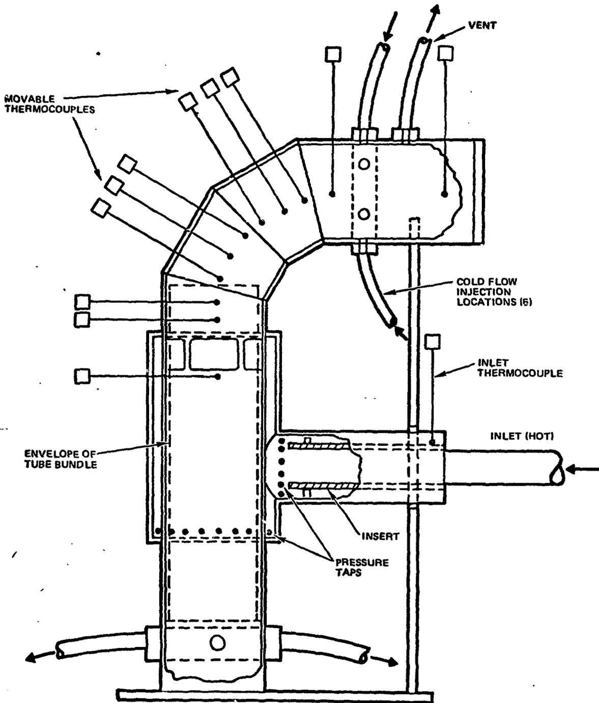
FIGURE 6. HYDRAULIC MODEL OF ELBOW REGION
