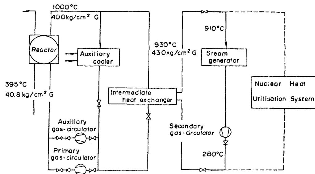
FIG. 1 SYSTEM DIAGRAM OF EXP. VHTR
