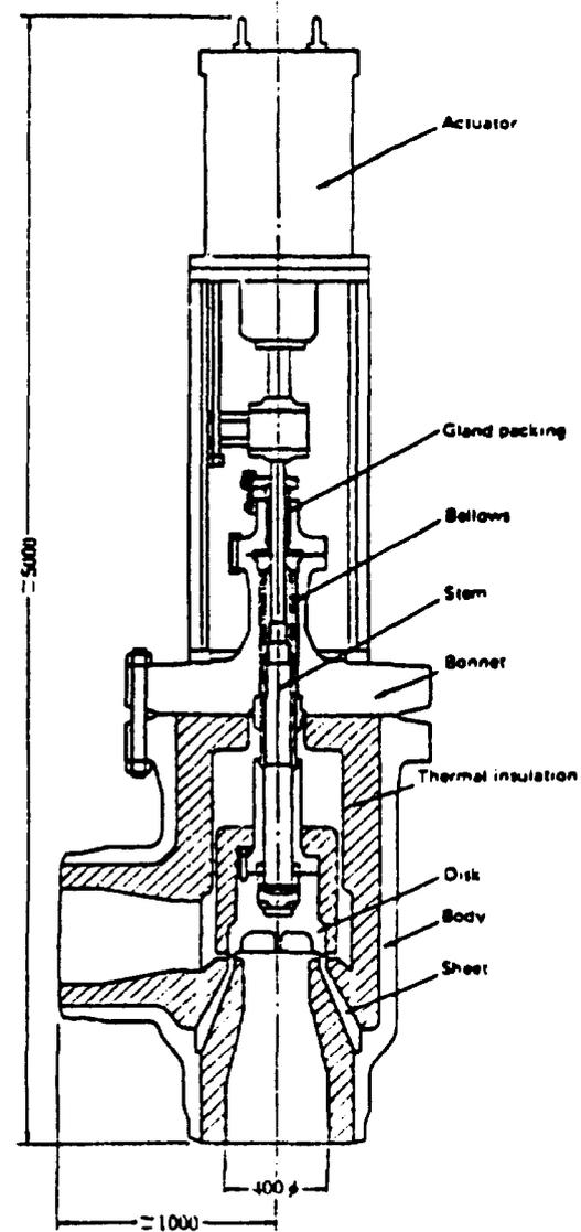
FIG. 5 HIGH TEMPERATURE ISOLATION VALVE
