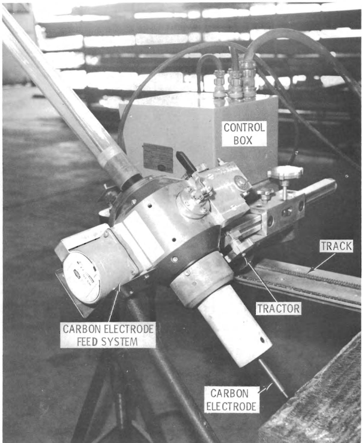
FIGURE 1. Air Arc Gouger
