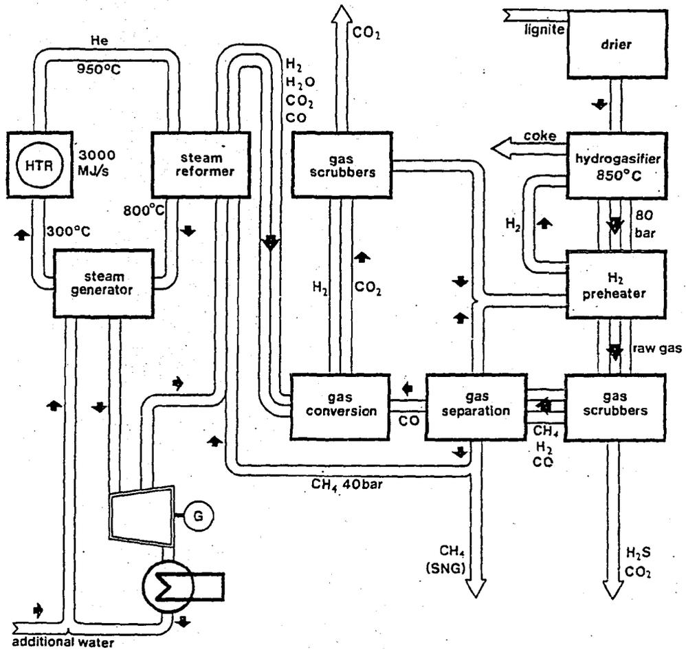
FIG. 1 HYDROGASIFICATION OF LIGNITE
