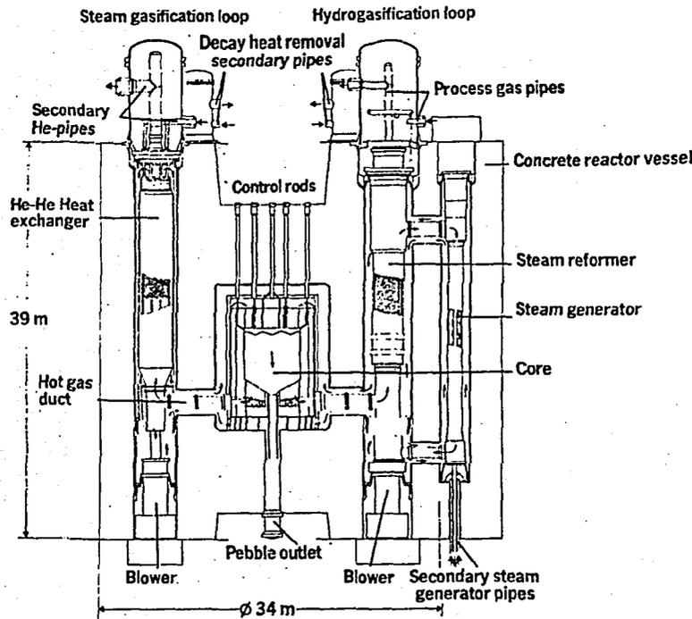
FIG. 6 HIGH TEMPERATURE REACTOR FOR THE PNP - PLANT
