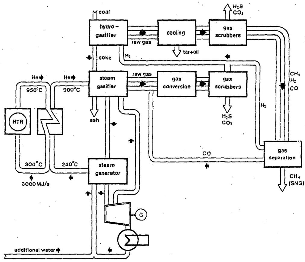
FIG. 2 COMBI-PROCESS OF HYDRO-STEAM GASIFICATION OF HARD COAL
