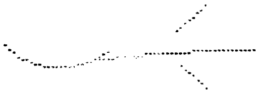
Рис. 2в. Данные рисунка 2а после предфильтрации. Условия предварительной фильтрации: 1) \gamma_{\max} = 32^{\circ} , 2) дескриптор вершины указывает на а) отсутствие выхода вторичных треков под углами более \gamma_{90} и б) наличие вторичных треков в задней полусфере.
