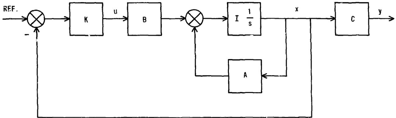
FIGURE 3: STATE - FEEDBACK CONTROLLER
