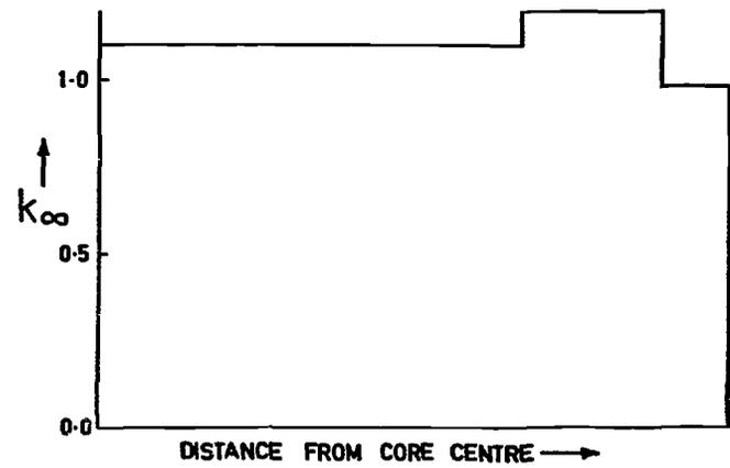
FIG.15 DISTRIBUTION OF ASSEMBLY  $k_{\infty}$  VALUES IN A BWR REFUELLING SCHEME
