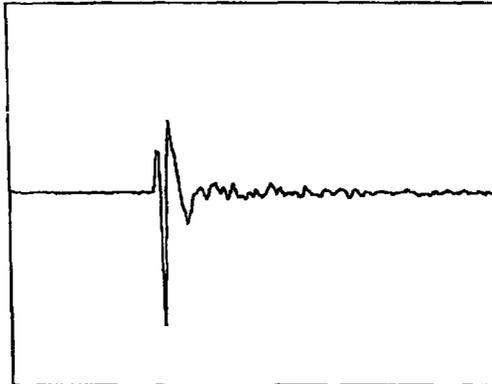
Figure : 20 - A.E. SIGNAL STANDARD FOR ACOUSTIC SURVEILLANCE
