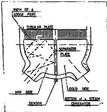
FIGURE 6 : HOT LEG STEAM GENERATOR BOTTOM HEAD.
