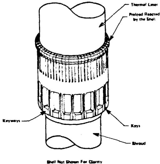
FIG. 12 VIBRATION DAMPER
