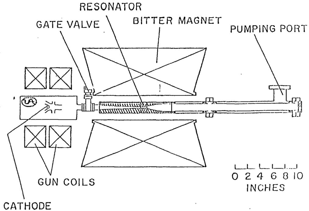
FIG. 3: M.I.T. 140 GHz GYROTRON
