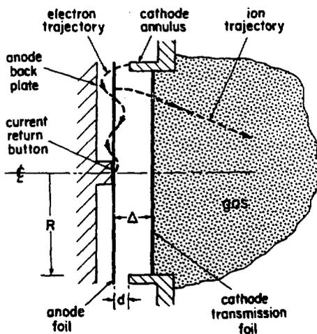
Fig. 2. Pinch-reflex-diode.
