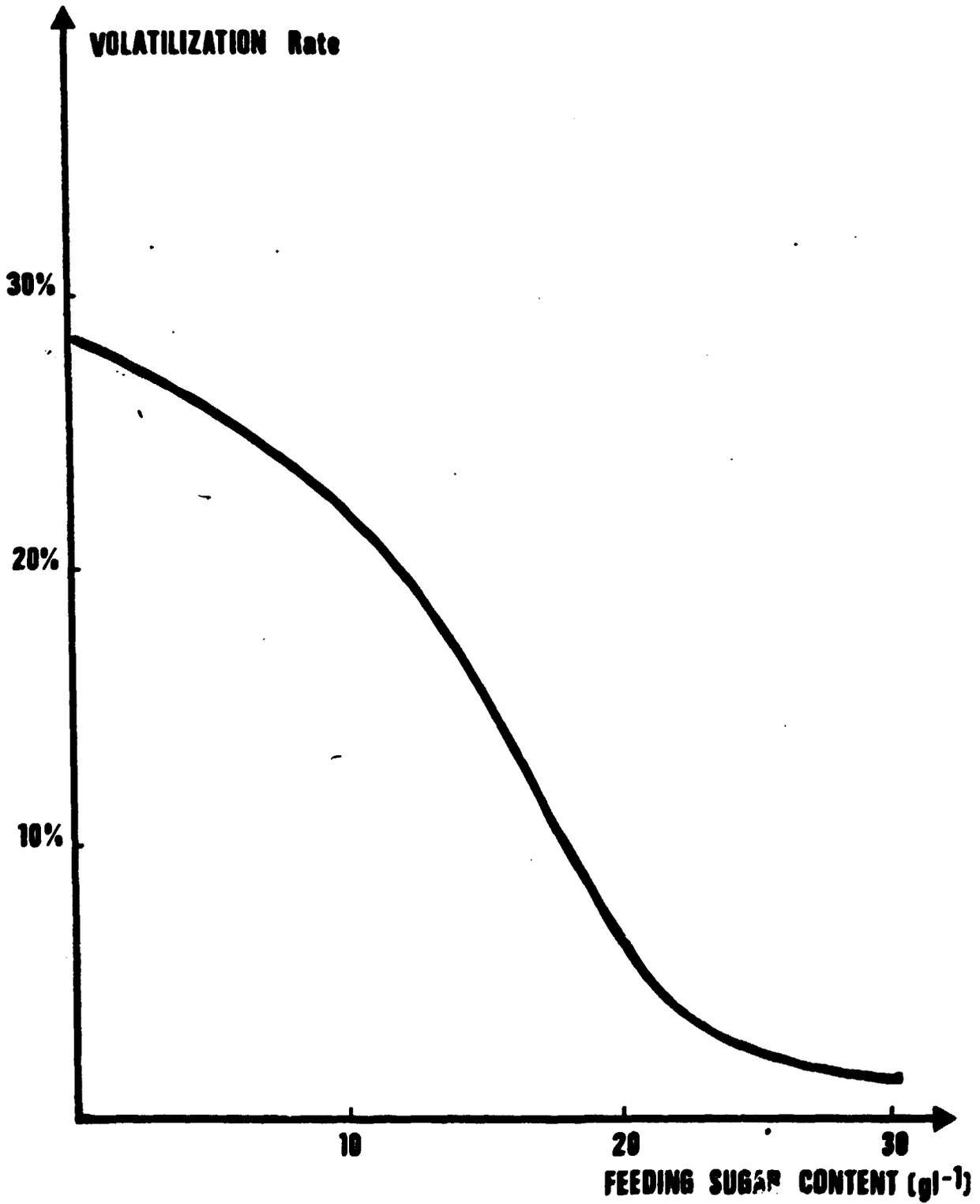
FIGURE 3: VOLATILIZATION OF  $^{106}\text{Ru}$  EFFECT OF SUGAR
