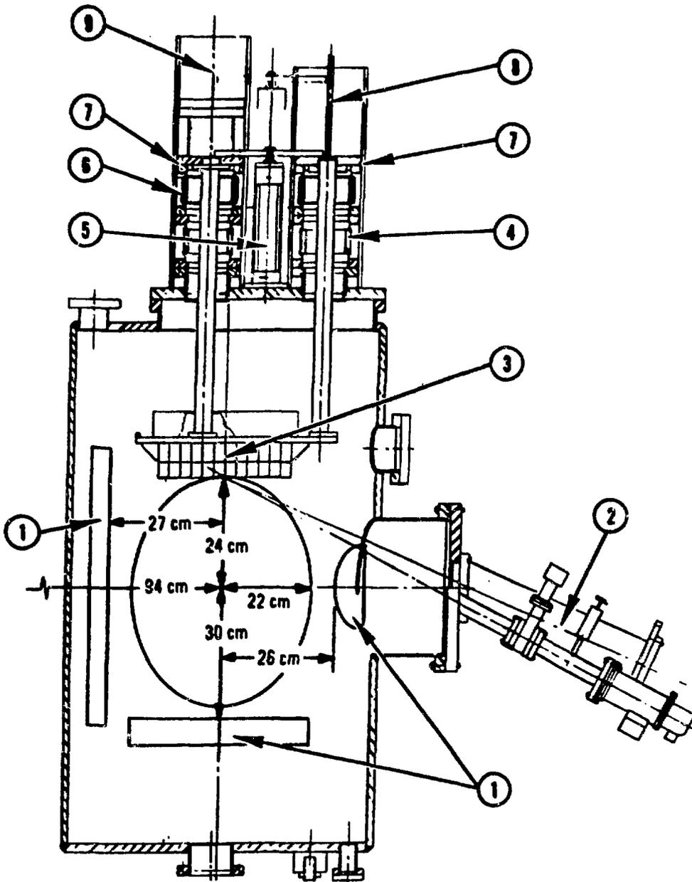
1-TOROIDAL PROJECTION OF TiC LIMITERS
