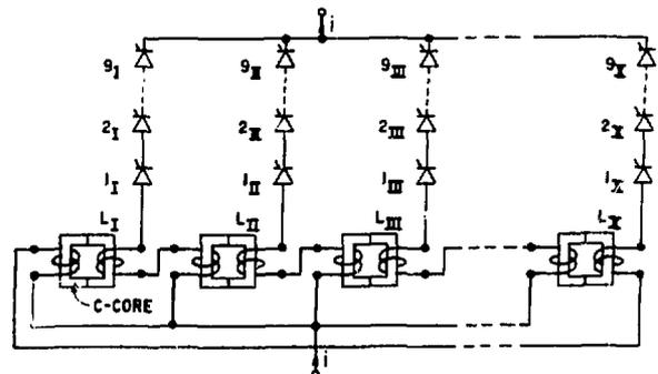
Fig. 7. Wiring of C-Cores
