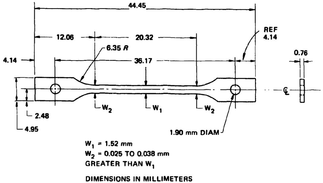
Fig. A.2. The SS-1 sheet tensile specimen.
