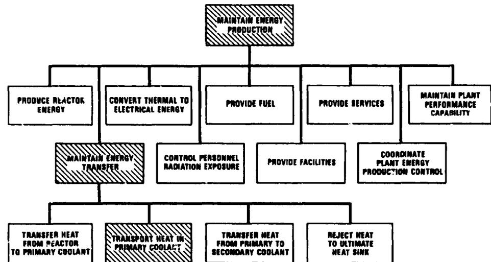
FIG. 10 CIRCULATOR FUNCTIONAL REQUIREMENT
