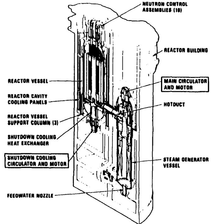
FIG. 4 350 MW(t) MODULAR HTGR ISOMETRIC
