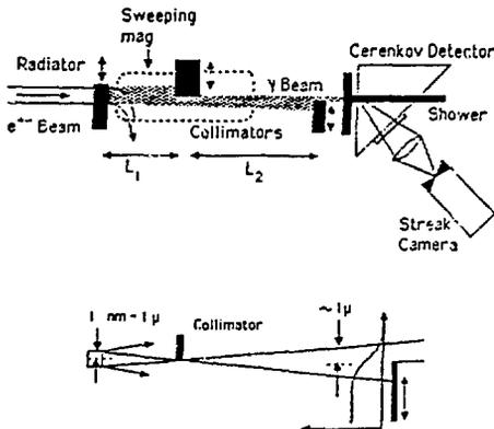
Fig. 1 Plan of Bremsstrahlung Monitor
