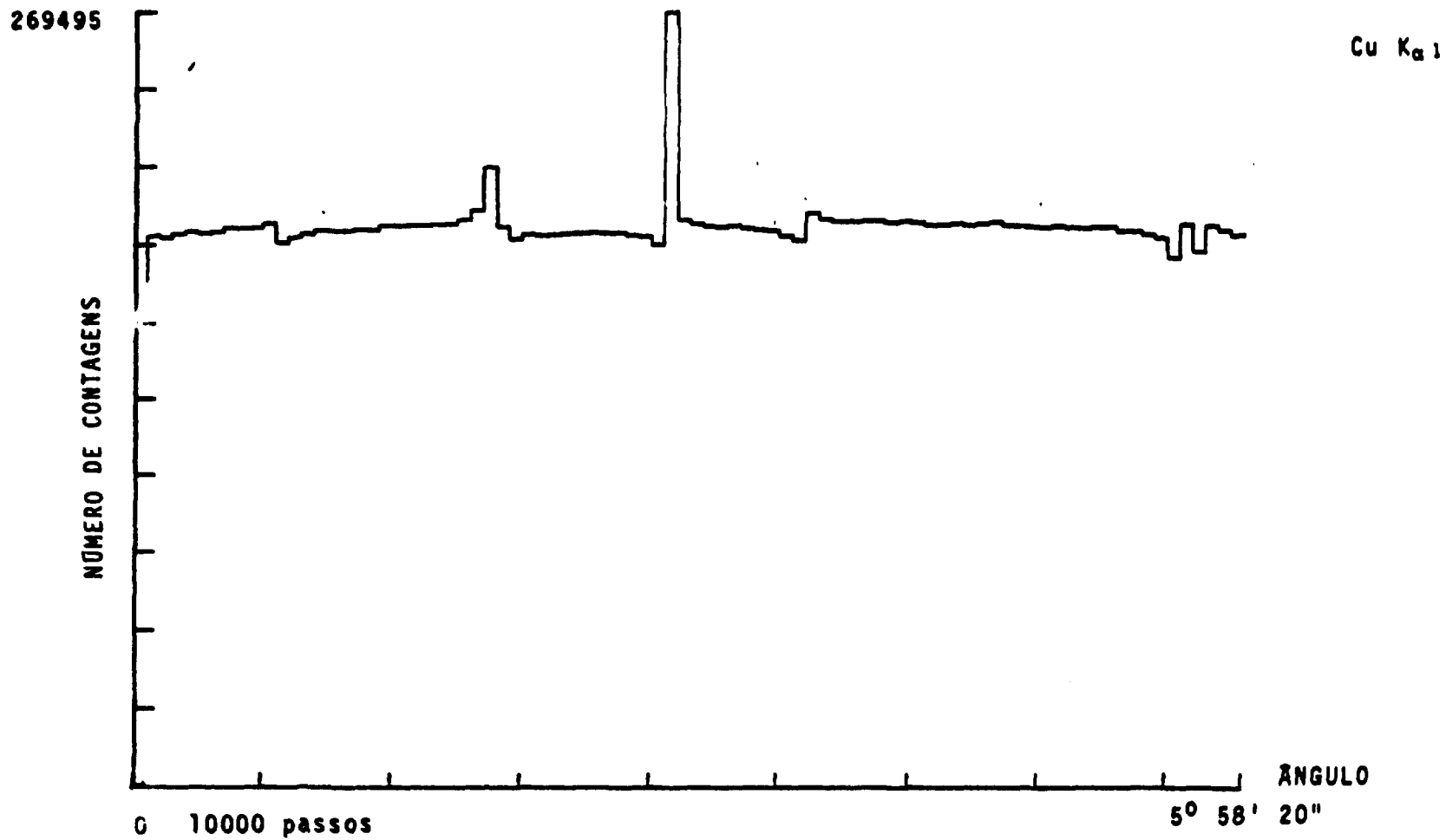
FIGURA IV.17 - Número de contagens em função do posicionamento angular da amostra 1, com a radiação CuK \alpha 1.
