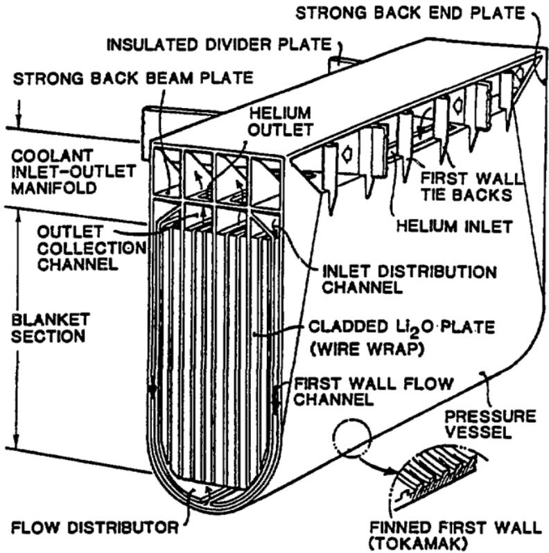
FIGURE 2 HELIUM-COOLED SOLID BREEDER BLANKET MODULE (1).
