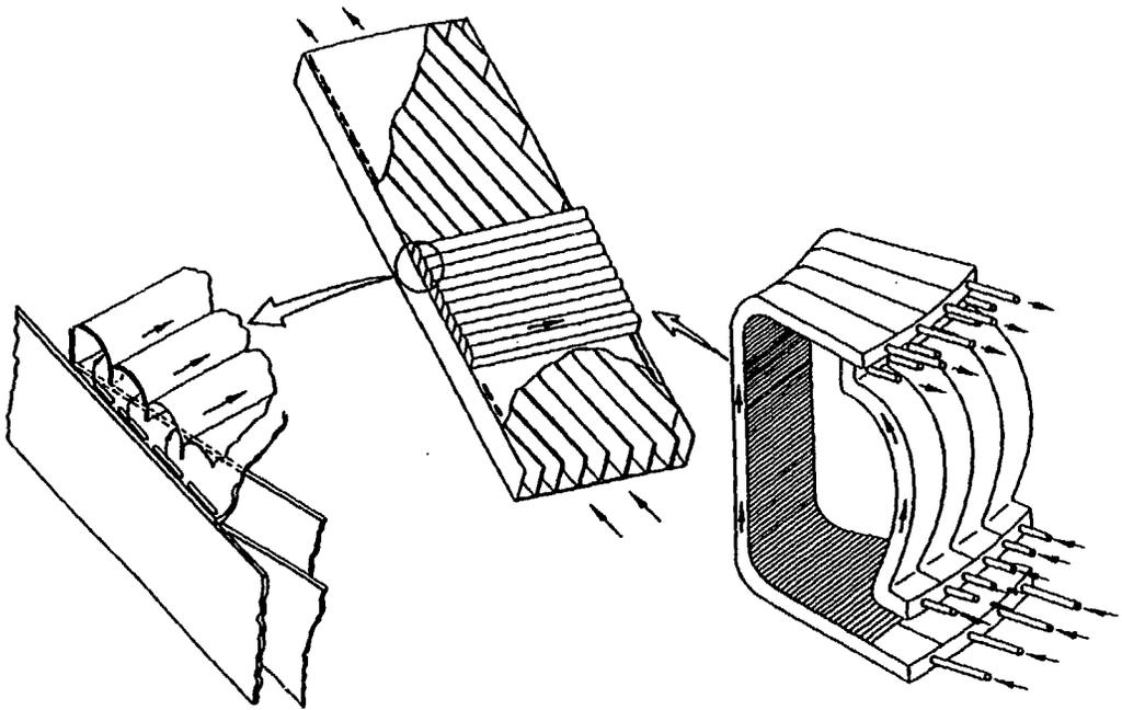
FIGURE 1 SELF-COOLED LIQUID METAL BLANKET SECTION FOR A TOKAMAK REACTOR (1).
