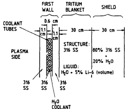
FIGURE 5: SCHEMATIC OUTLINE OF AQUEOUS LITHIUM SALT BLANKET.
