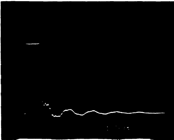
10 V/div.; 100 ns/div. Foto 4. Voorflank puls primair.
