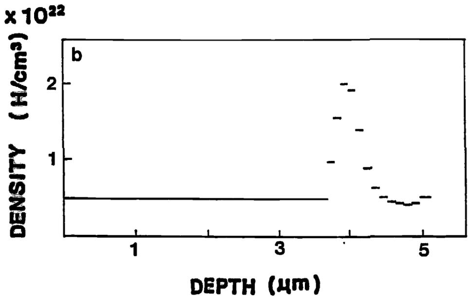
**Fig. 5.a** : Evidence for fluid hydrogen rich inclusion in glass ( $E_0$  : 3 MeV ;  $i$  : 0,7 nA ; beam diameter : 30  $\mu\text{m}$  ;  $t$  : 1800 s)
