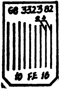
图4 透变计a—— \phi 0.07\text{mm} 康铜丝； b—— \phi 0.03\text{mm} 康铜丝。
