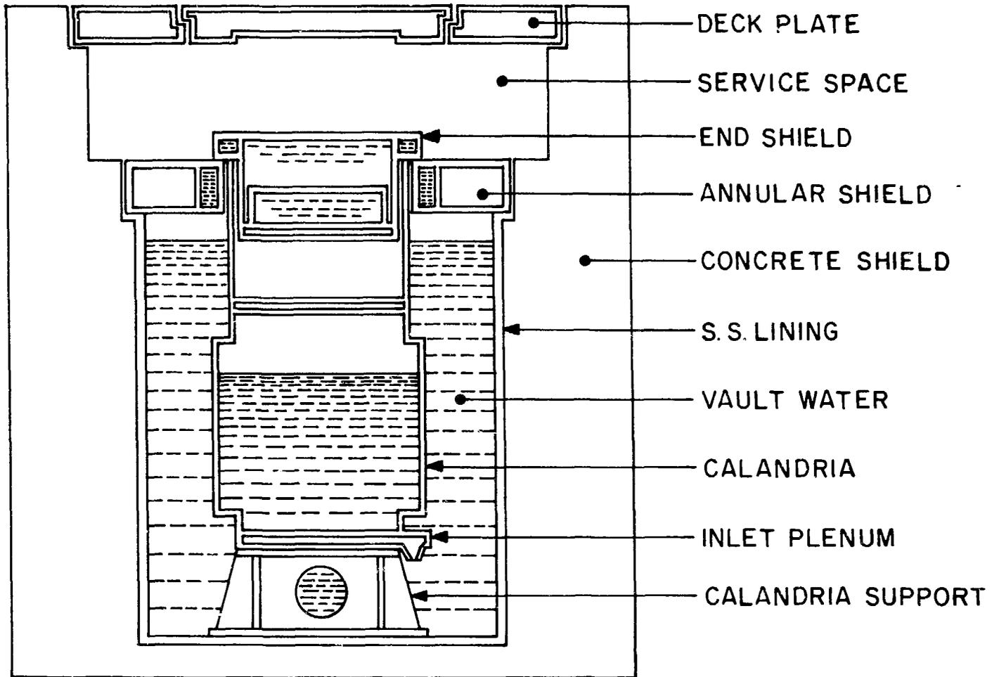
Fig. 2 PILE BLOCK SCHEMATIC
