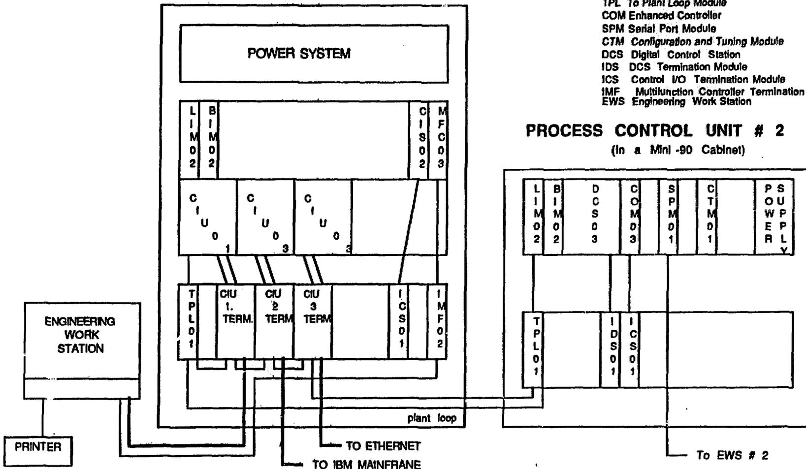
FIGURE 8: BAILEY NETWORK 90 SYSTEM FOR INTELLIGENT DISTRIBUTED CONTROL LAB
