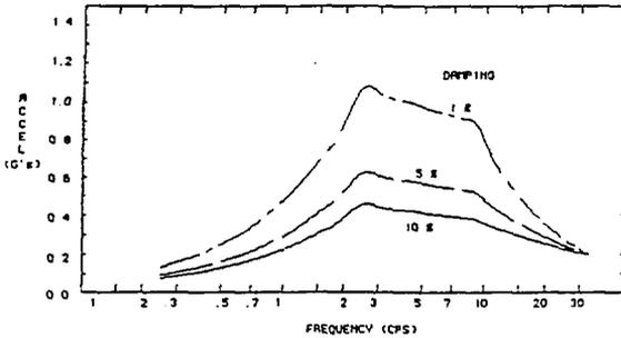
Fig. 6 REG GUIDE 1.60 FREE FIELD SPECTRA
