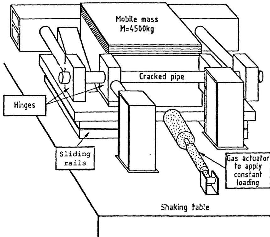
Fig. 3 - TEST FACILITY FOR DYNAMIC TESTS ON STRAIGHT PIPES
