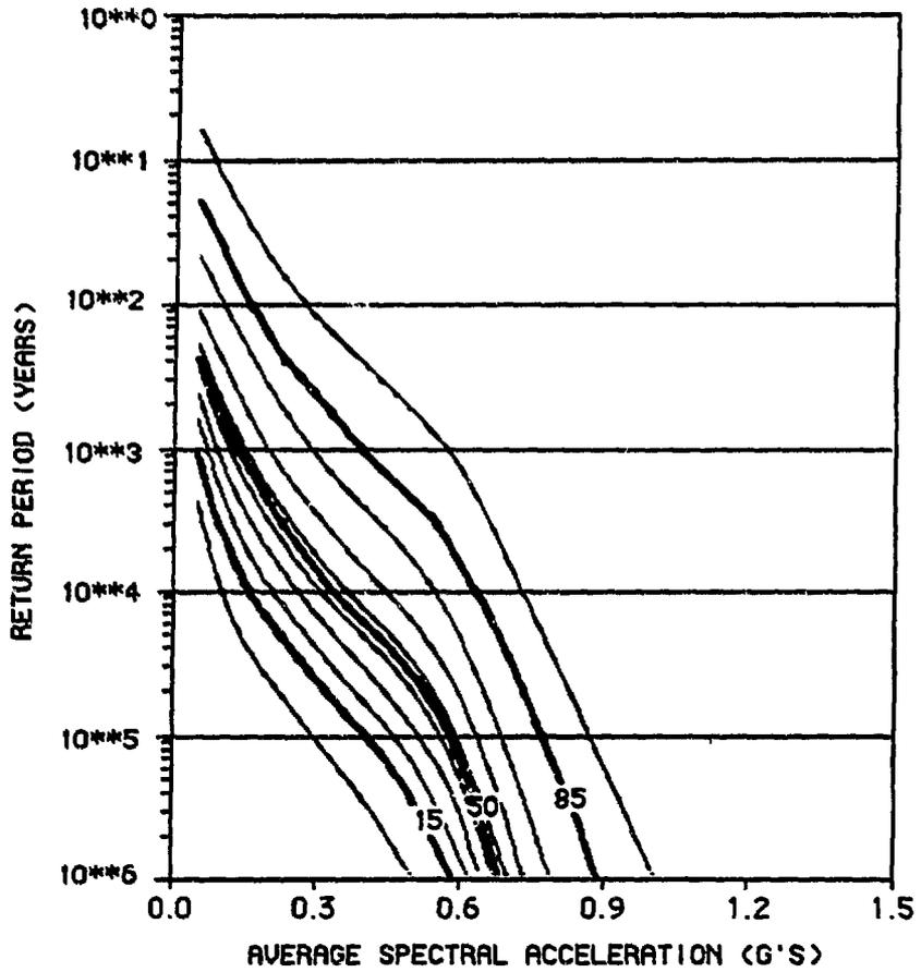
**FIGURE 8 COMPUTED SURFACE SEISMIC HAZARD
