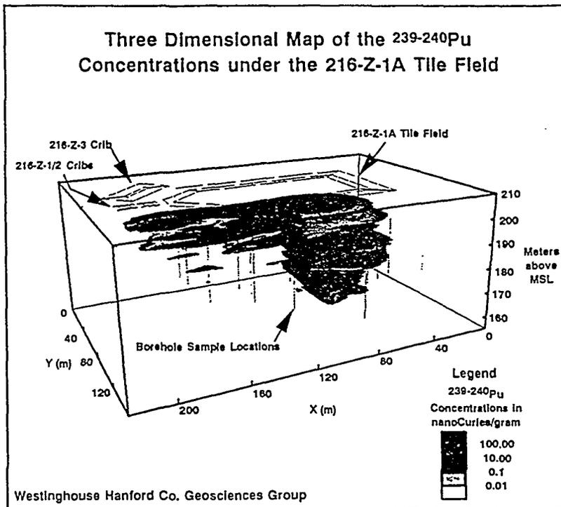
FIGURE 3. DISTRIBUTION OF PLUTONIUM AT THE 216-Z-1A TILE FIELD.
