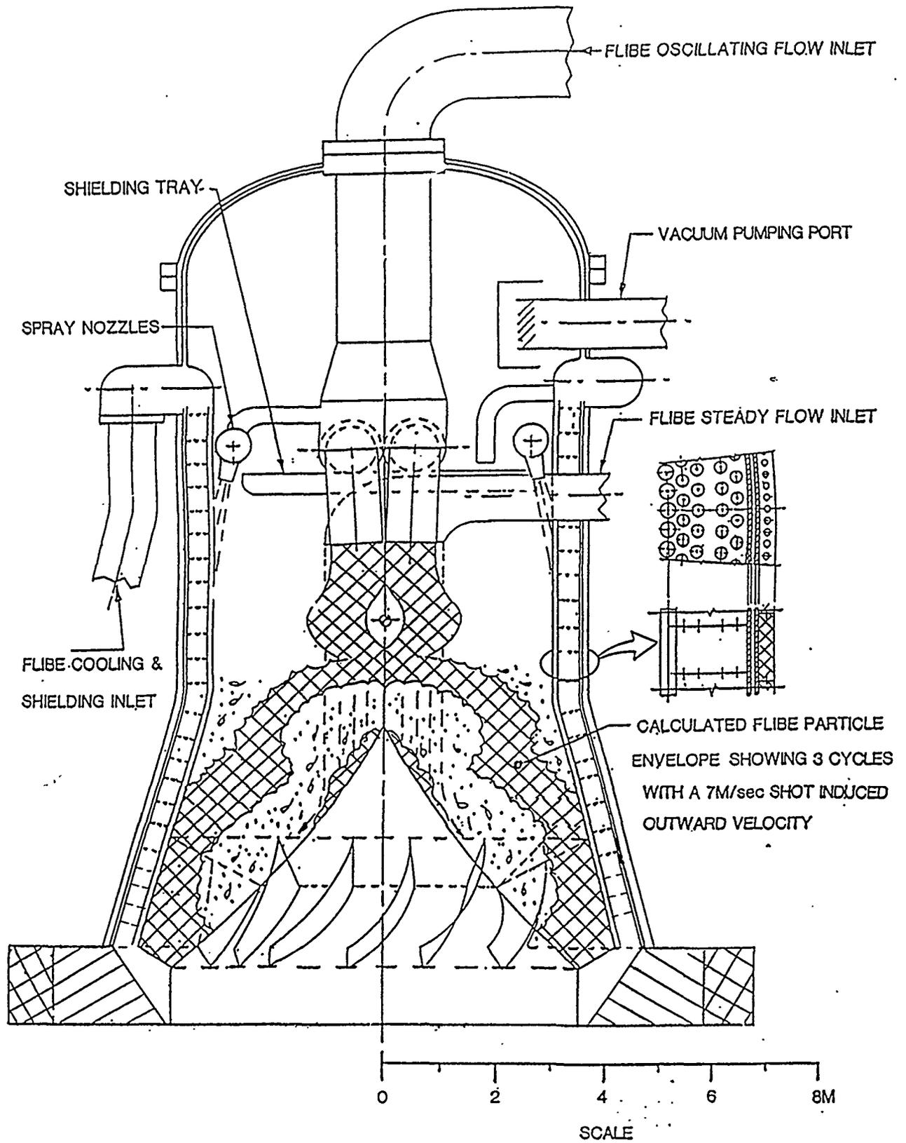
FIGURE 1. HYLIFE II REACTOR VESSEL
