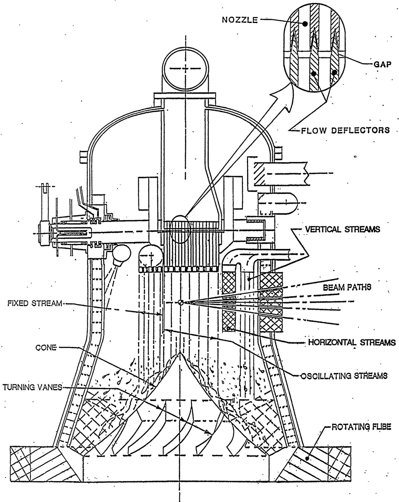
FIGURE 4. FLIBE SHIELDING STREAMS
