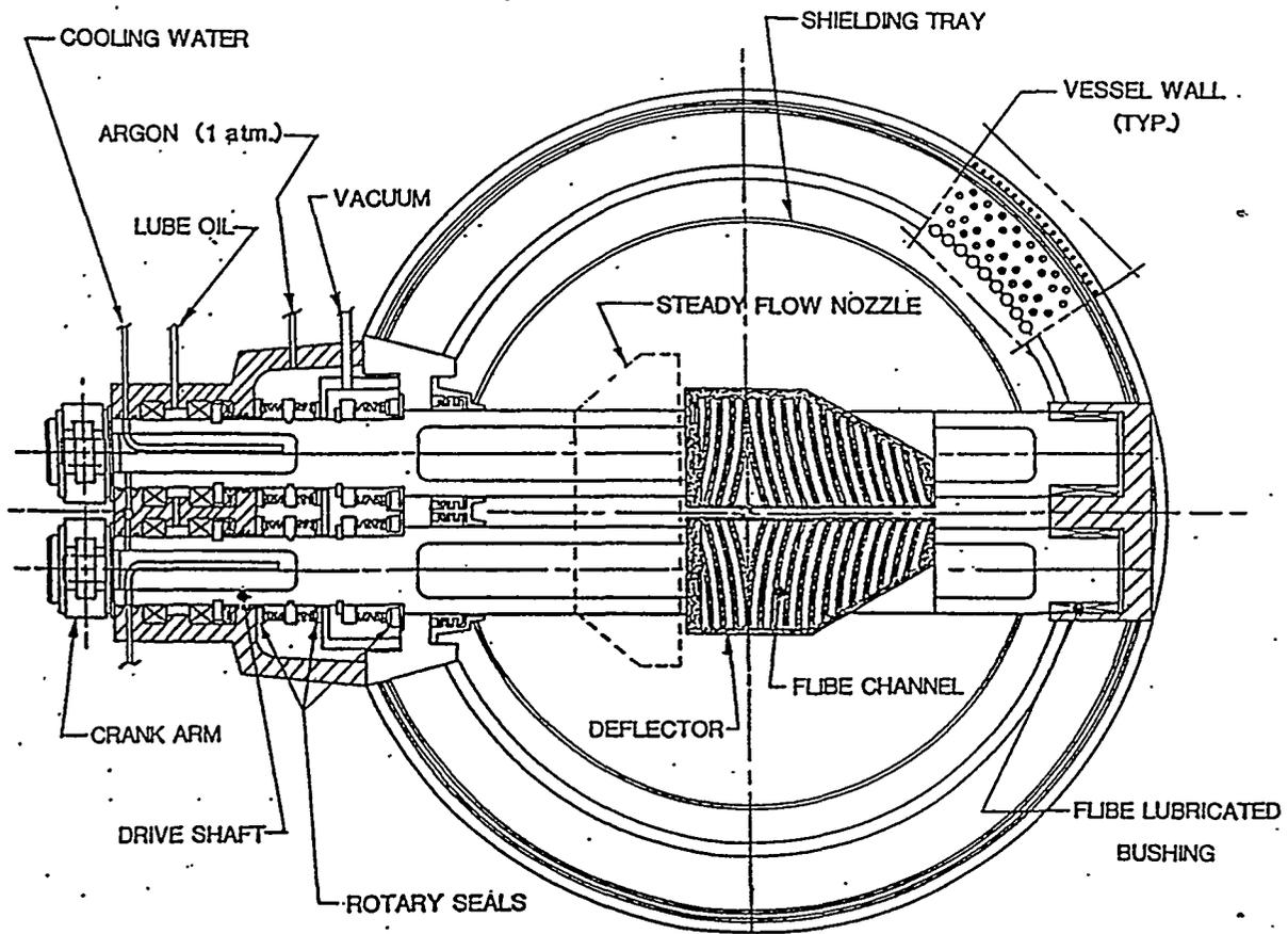
FIGURE 5. FLIBE DEFLECTOR DRIVE SHAFTS
