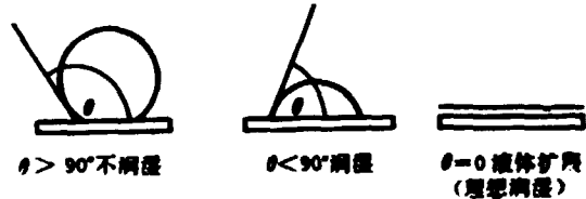
图8(b) 液体在固体上的附着情况
