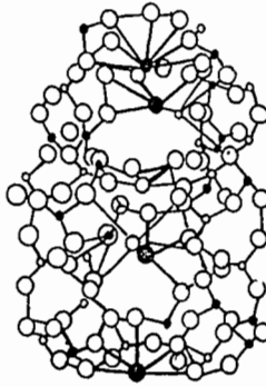
FIGURA 6. ESTRUCTURA MOLECULAR DE LA CLINOPTILOLITA PROYECTADA EN EL PLANO (0 0 1) (● silicios, ◐ aluminos, ○ oxígenos)
