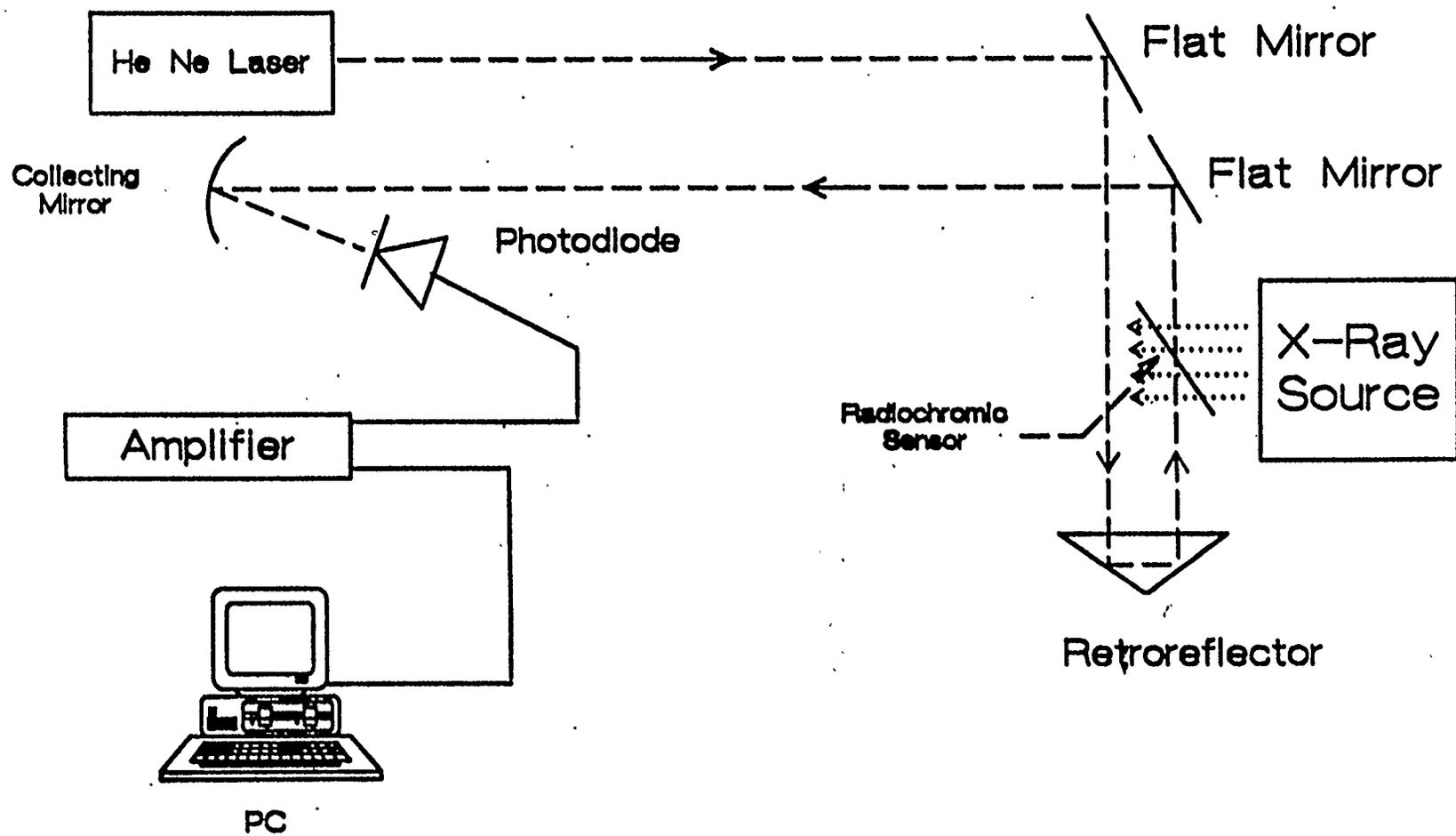
Figure 9 - Laser-Telemetering Dosimetry System.
