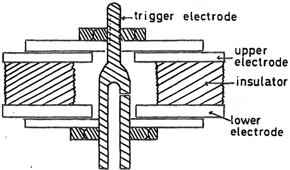
Fig. (5) Blumlein spark gap switch
