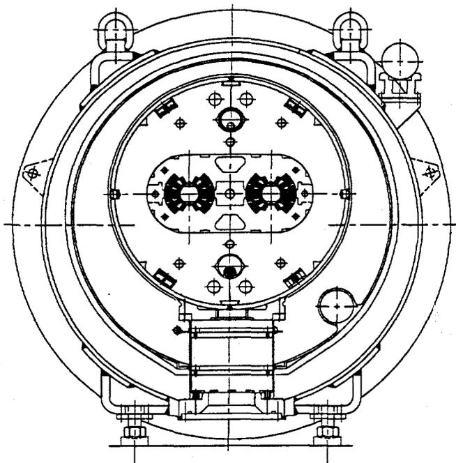
Fig. 2 LHC dipole
