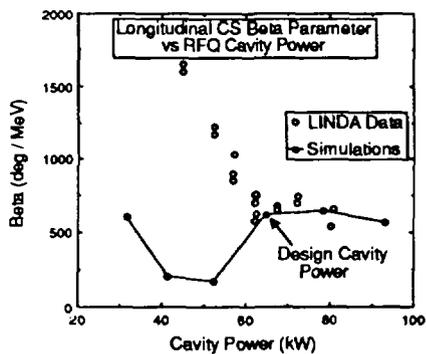
Fig. 8. The longitudinal CS  $\beta$  parameter vs RFQ power.
