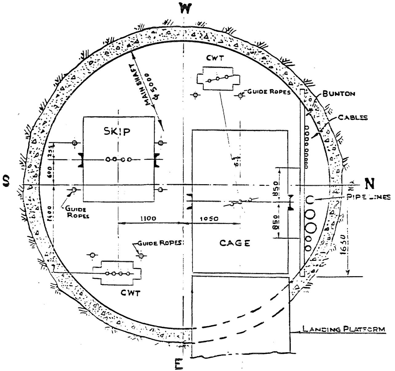
FIG. 4. Shaft plan.
