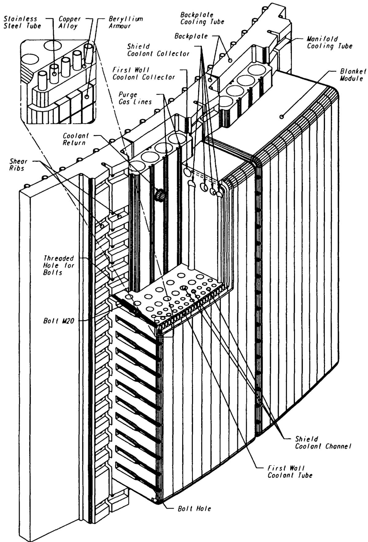
Fig. 4. Blanket Shield Module
