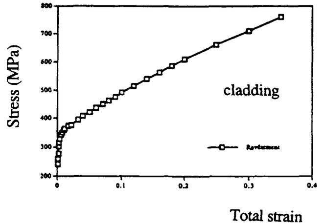
FIG 11. STRESS - STRAIN CURVES
