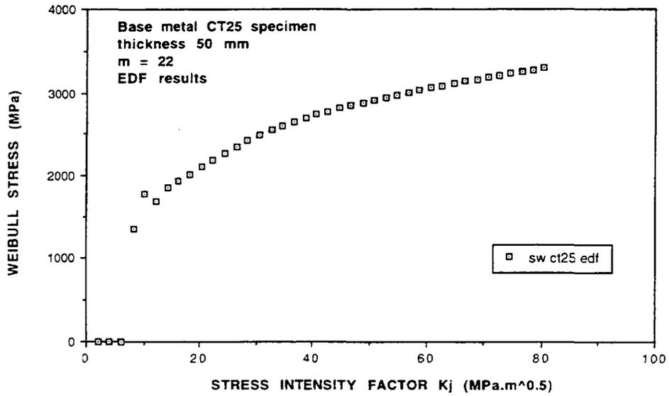
FIG 14. WEIBULL STRESS  $\sigma_w$  VERSUS STRESS INTENSITY FACTOR  $K_I$  (CT SPECIMEN)
