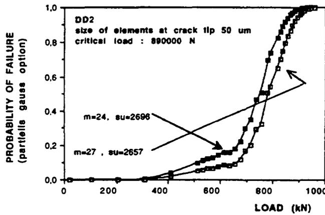
FIG 3. PROBABILITY OF FAILURE VERSUS LOAD FOR CLADED MOCK-UPS DSR4, DSR1, DD2
