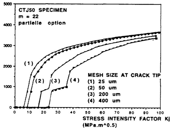
FIG 2. WEIBULL STRESS  $\sigma_w$  VERSUS STRESS INTENSITY FACTOR  $K_I$  (CT SPECIMEN)
