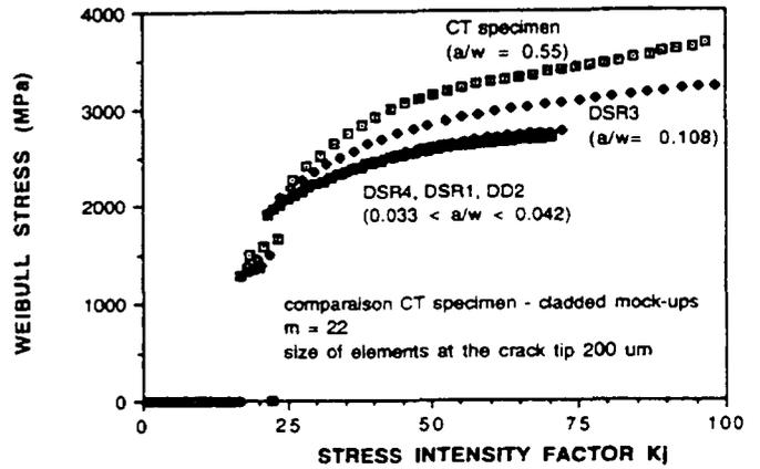
FIG 5. WEIBULL STRESS  $\sigma_w$  VERSUS STRESS INTENSITY FACTOR  $K_I$  CURVE. COMPARISON BETWEEN CT SPECIMEN AND CLADED MOCK-UPS
