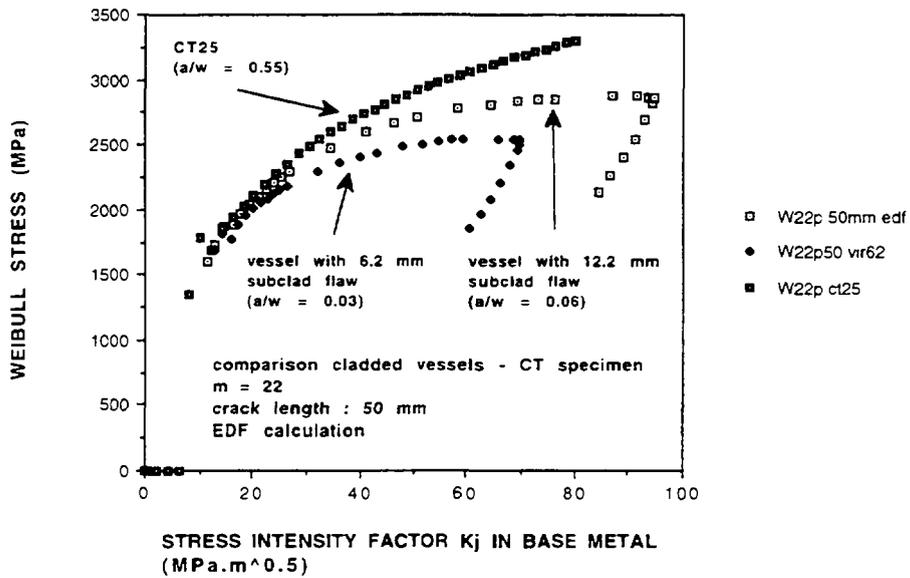
FIG 15. COMPARISON BETWEEN CLADED VESSELS AND CT SPECIMEN USING BEREMIN MODEL ( $\sigma_w$  VERSUS  $K_I$  CURVE)
