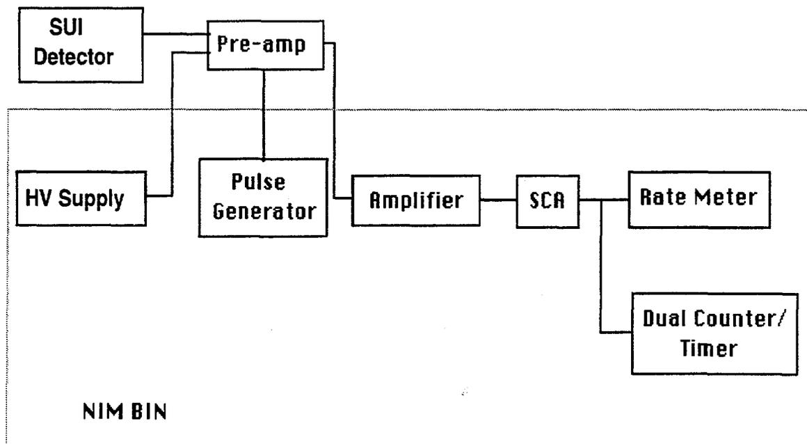
FIGURE 1. BLOCK DIAGRAM OF SUI SYSTEM SETUP
